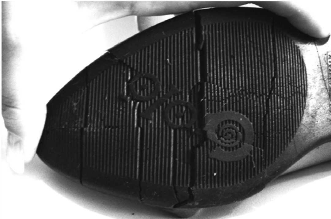
Abb.20: Typisches Schadensbild bei gealtertem Gummi. Die Sohle bricht, bröseln, reibt ab und ist klebrig.
